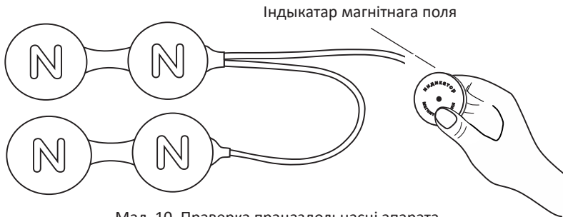
Мал. 10. Правэрка працаздольнасці апарата з дапамогай індыкатара магнітнага поля
